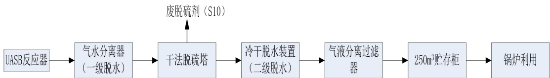
图 3.2-6 沼气净化流程简图
