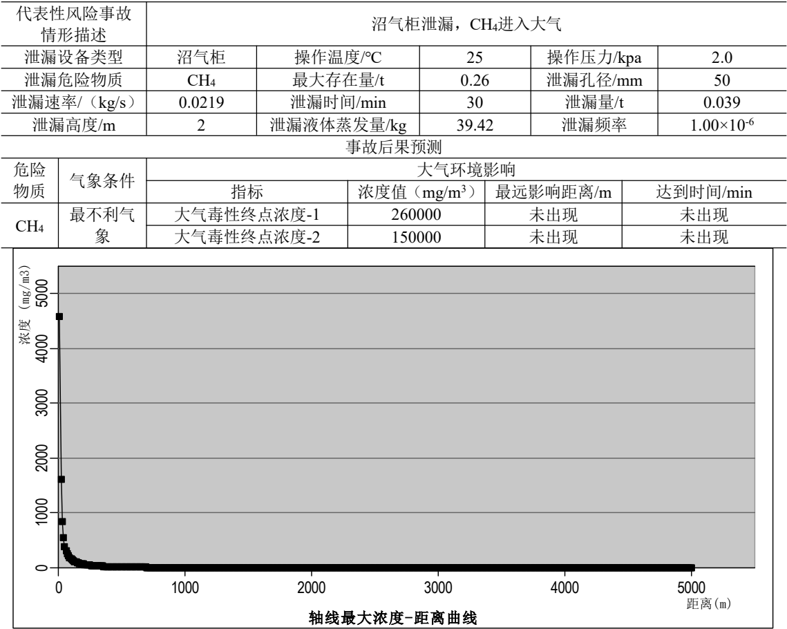
图7.7-4 沼气柜泄漏在最不利气象条件下风向CH 4 最大浓度-距离曲线图
