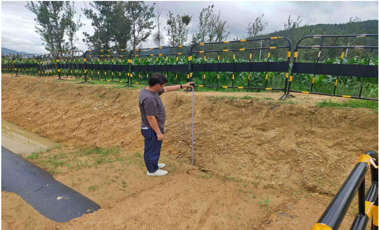
照片 5-4 量取园地区土层厚度
