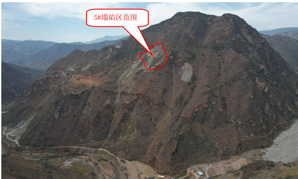
照片 3-6 5#地面塌陷坑山体斜坡下游威胁对象
