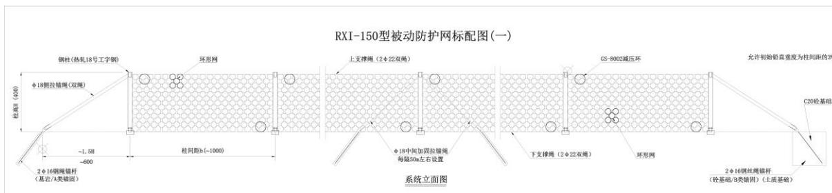
图 5-1 被动防护网设计立面图
