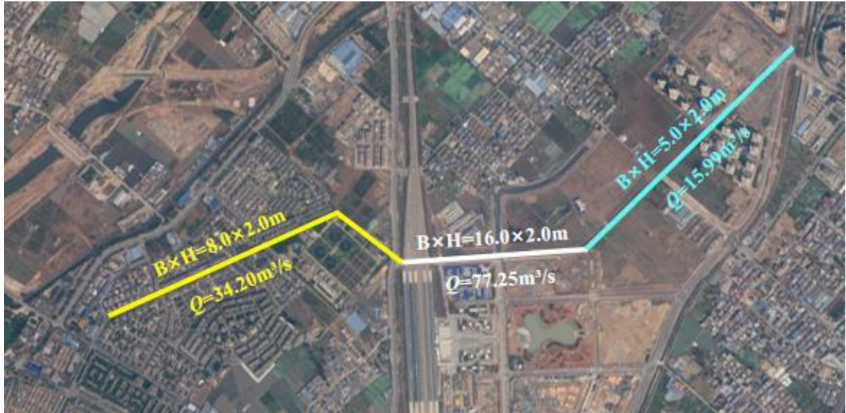
图 3-1 中心沟现状断面尺寸示意图
