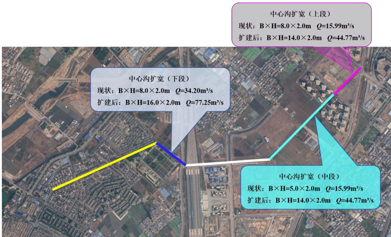
图 3-2 中心沟扩宽断面尺寸示意图
