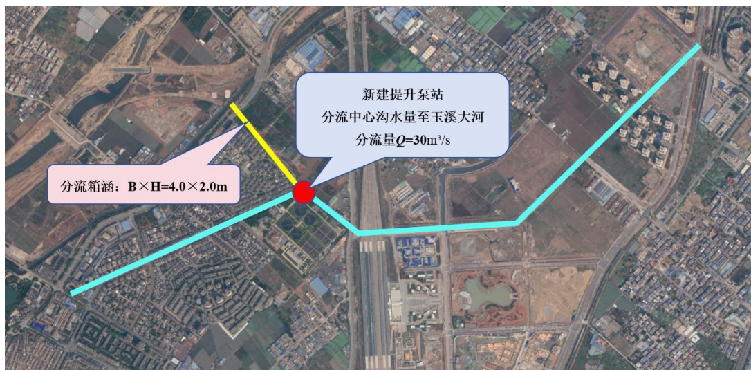
图 4-1 中心沟分流箱涵及分流泵站示意图
